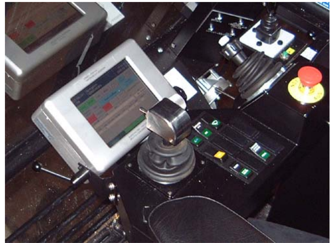
Abb. 1 Installation auf einem Enteiser für Flugzeuge
