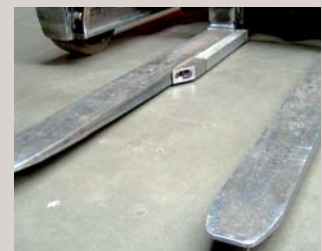
3 Die Kamera ist an der Gabelzinke installiert
