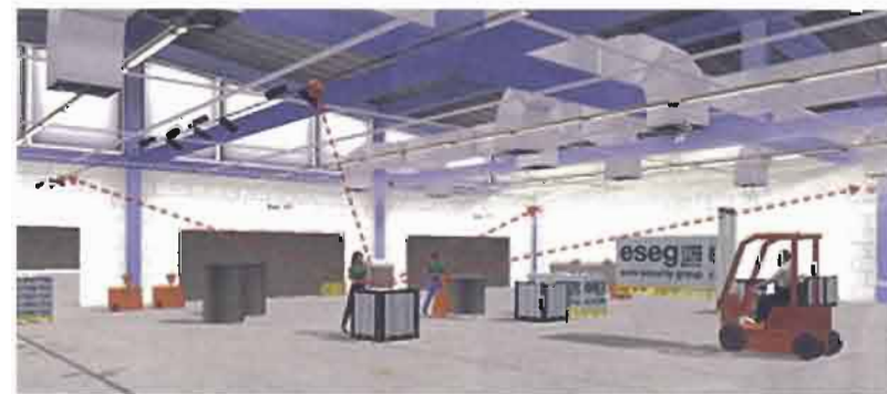
Das Ortungssystem der Firma Solcon funktioniert über innen befestigte Ankerpunkte.
