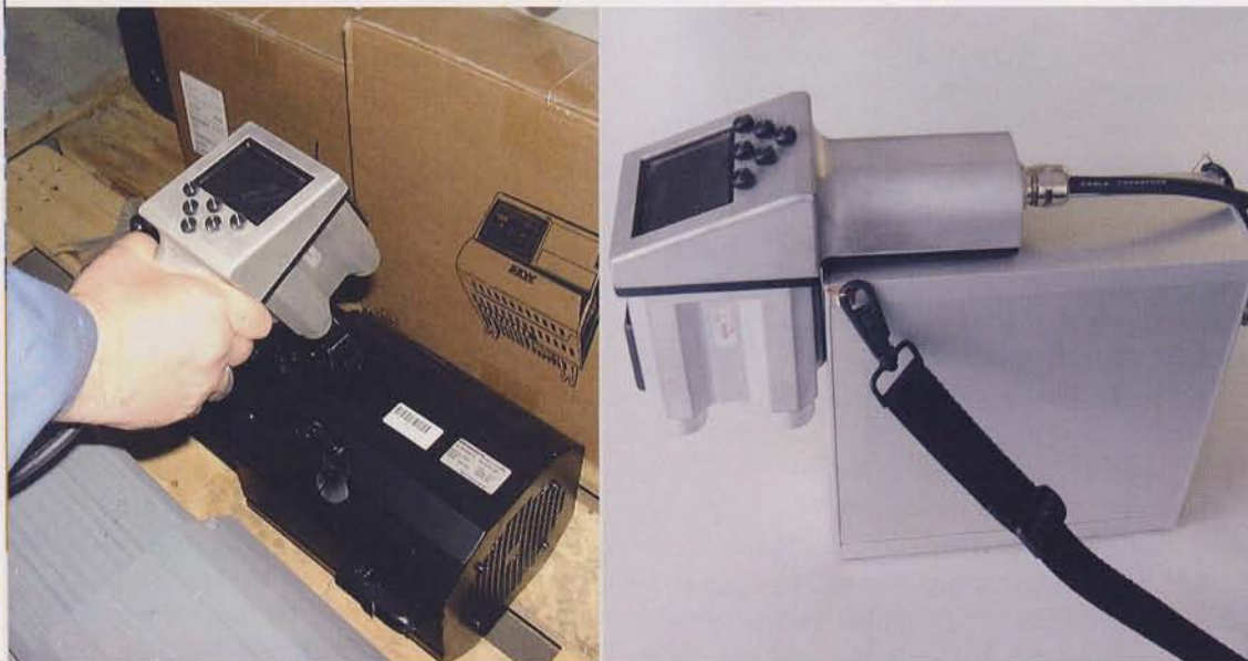
Der Mobile-Reader von Solcon ist mit einem 3,2"-Display ausgestattet, welches sowohl das Bild als auch Statusinformationen anzeigt. Das Gerät ermöglicht auch die Zusammenarbeit mit übergeordneten Systemen wie SAP.
